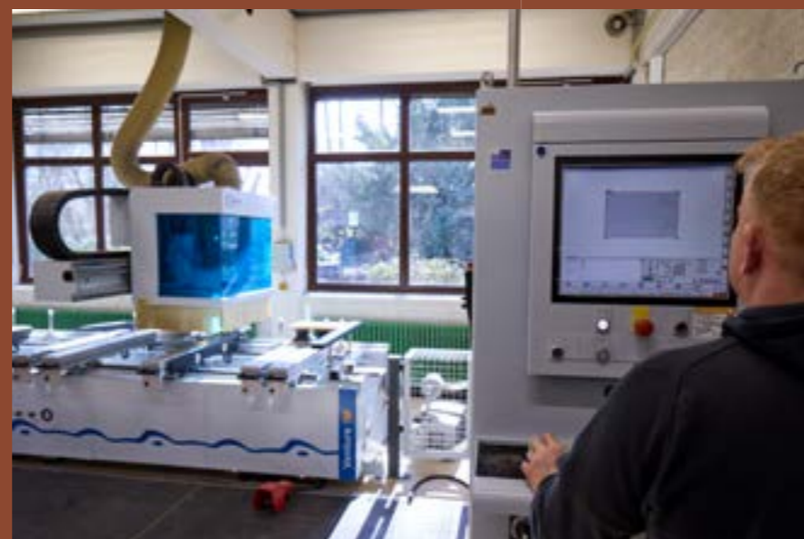
CNC-Bearbeitung von Holz und Kunststoffen: Fräsen, Bohren, Nut- und Fräskonturen nach Vorgaben; Serien- und Einzelteilfertigung mit wiederholbarer Genauigkeit.
