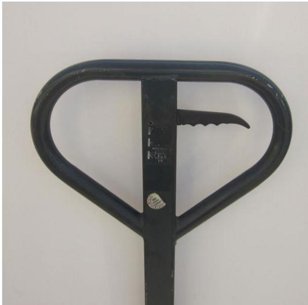
Mit dem Hebel am Handgriff kann der Hubwagen gehoben oder gesenkt werden.
