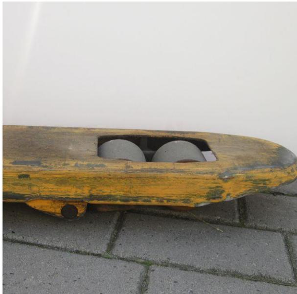
Die Hinterachse wird durch Auf- und Abbewegungen der Deichsel angehoben oder gesenkt.
