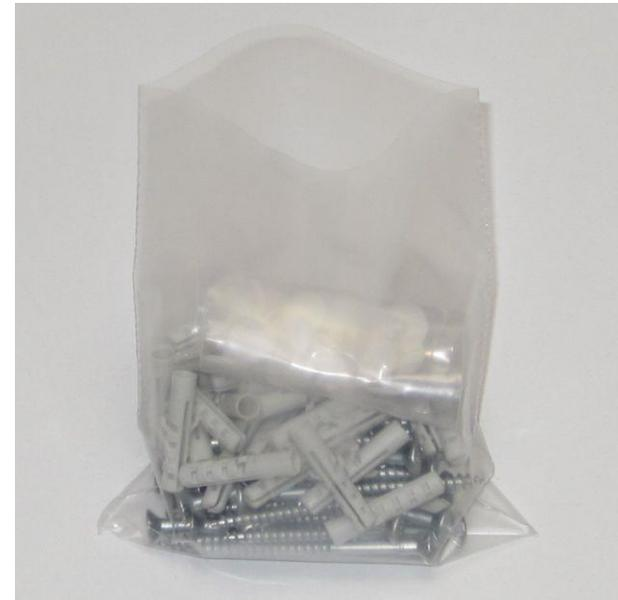
Die abgezählten Dübel werden lose in die PE-Beutel mit den Schrauben gefüllt. Oben drauf wird ein Beutel mit Abdeckkappen gelegt.
